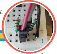
**9** Conecta [I, 1] con [I, 4] usando un tramo de 2 cm de alambre.
