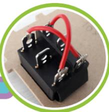
**20** Conecta el cable naranja del UTP en la terminal de en medio del mismo *switch* donde conectaste los cables del portapilas, de manera que quede del mismo lado del cable negro que conectaste en el paso 18.
