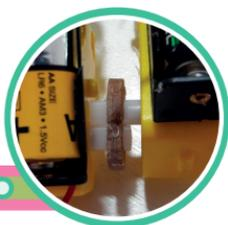
**8** Identifica hacia donde giran los ejes de los motores y pega cada portapila en la parte posterior de cada motor, de manera que queden verticales en la misma posición.
