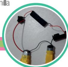
**5** Conecta en el extremo libre de la laminilla dorada del motor 1 un cable negro, y el extremo libre de este cable conéctalo en un extremo de la laminilla dorada del motor 2.
