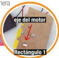
**5** Coloca las pilas en el portapilas y fíjalo con los tornillos M3 de cabeza plana, en el mismo rectángulo en el que sujetaste el motor. Así como se muestra en la imagen.
